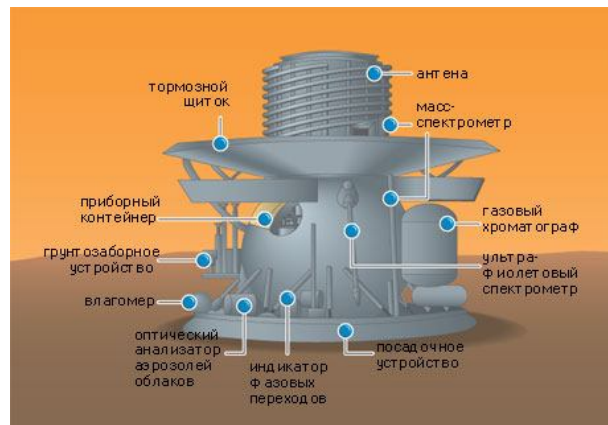
Вид АМС «Венера-14». Такой же вид имели аппараты серии «Венера», начиная с «Венеры-9». Изображение с ресурса http://www.geokhi.ru/~meteorit/burba-ven.html
